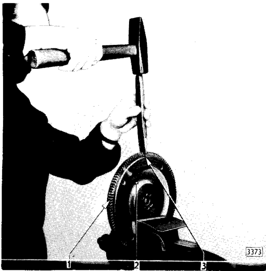
Sectionnement de la couronne de lancement
