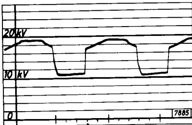
Court-circuit dans une diode d'excitation
