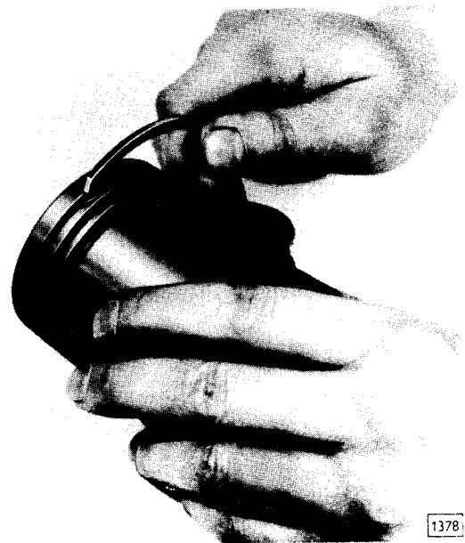
Décalaminage d'une gorge de segment
