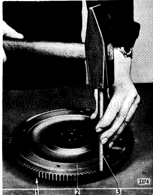
Mise en place de la couronne de lancement.
