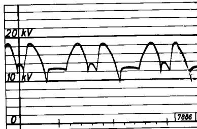
Court-circuit dans une diode positive
